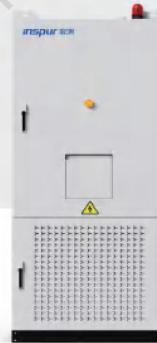
50KW/100kWh储能一体柜产品是一款高性能的能量储存系统，标称容量100kWh，额定功率50kW，专为满足工商业领域对稳定、可靠电力供应的需求而设计。该产品采用模块化系统配置，灵活匹配各类工商业场景，支持并离网自动切换，切换时间毫秒级，且支持并联扩容，方便系统扩展。此工商业储能产品适用于对电网连续性要求较高的应用场合，可用于削峰填谷、后备电源、光储一体使用，还适用于微电网场景的应用。
